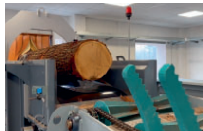
Obr. 5–6 – Unikátny experimentálny 3D CT skener na skenovanie tvrdej guľatiny
