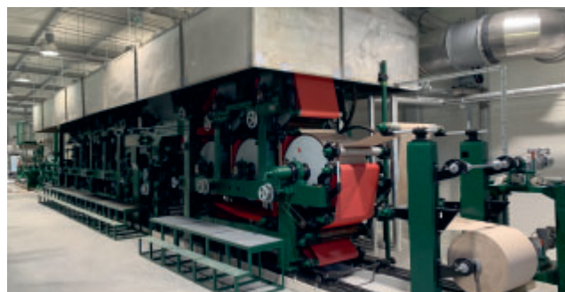
Obr. 3 – Univerzálny experimentálny papierenský stroj s tromi nátokovými skriňami, dvomi sitovými časťami, on-line integrovaným glejácim lisom a s univerzálnou sušiacou časťou s piatimi sušiacimi sekciami vrátane Yankee valca.
